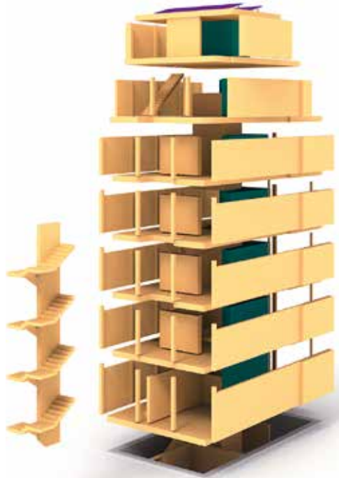
Abb. unten_Konstruktionsprinzip eines hochgradig vorgefertigten Elementbaus.
