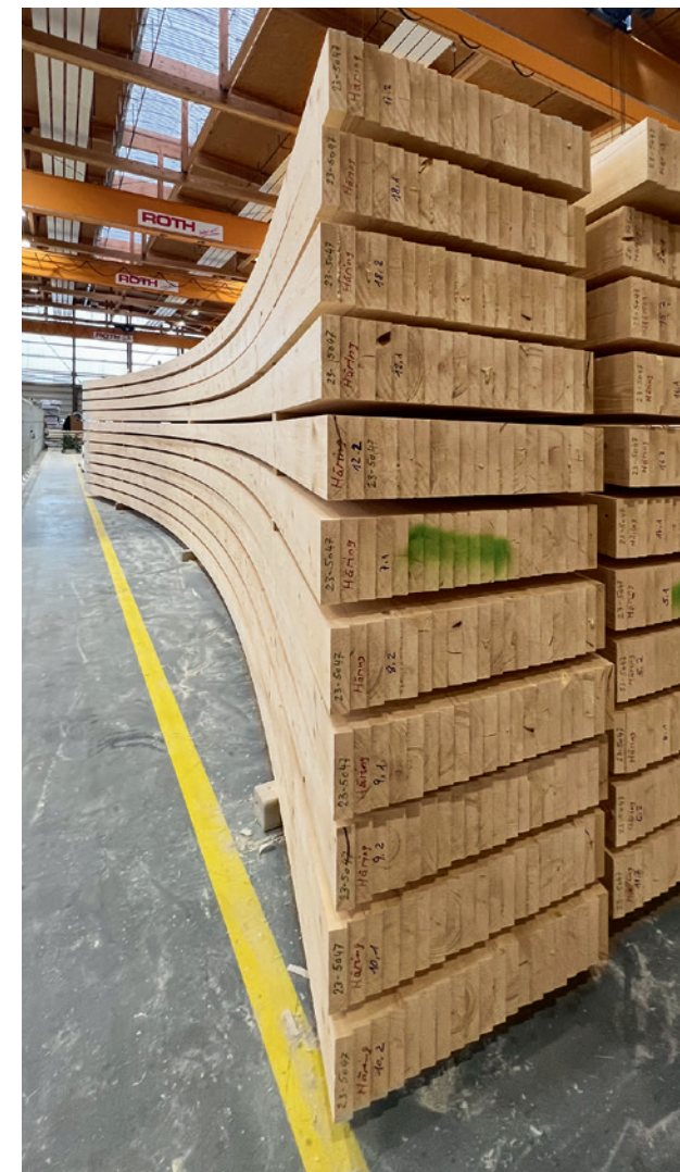
Abb. oben_Produktion der Brettschichtholzelemente bei Roth Burgdorf.
